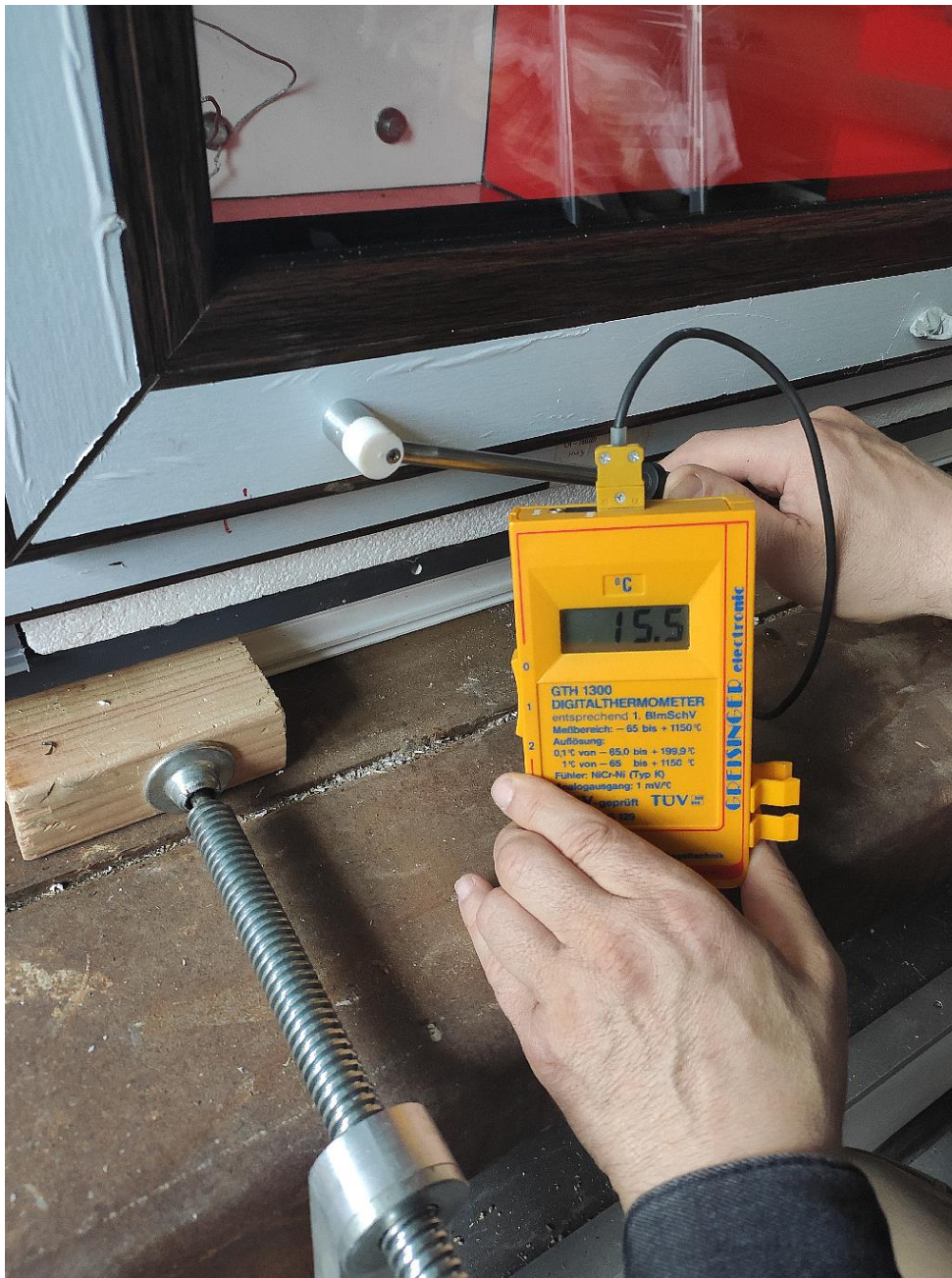
Рис. 11. Оконный блок Deseuninck Favorit Space. Замер температуры поверхности створки оконного Deseuninck Favorit Space 76 мм.
