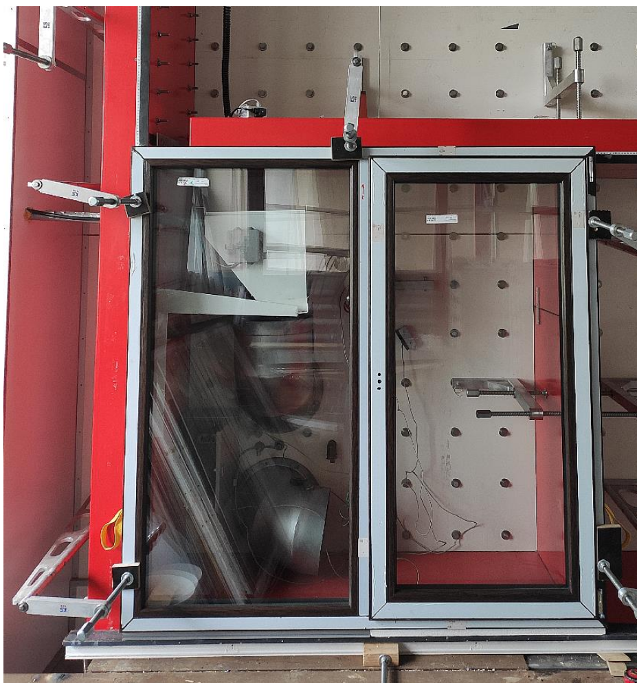
Рис. 4. Оконный блок системы Deseuinck Favorit Space с установленными подставочными профилями: COMPAFOAM® и USTK 25.
