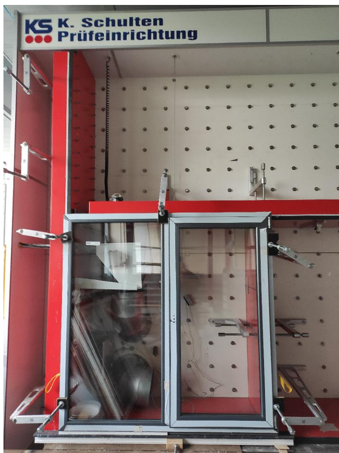
Рис. 3. Испытания оконных блоков с подставочным монтажным профилем СОМРАСFOAM®.
