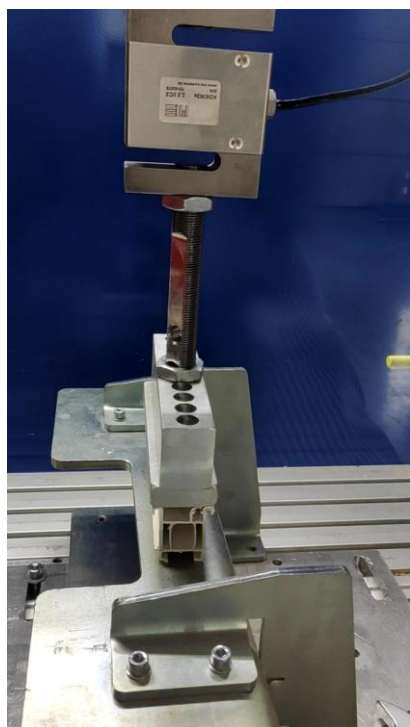
Рис. 30. Испытания на определение предельной прочности на сжатие стандартного монтажного подставочного профиля.
