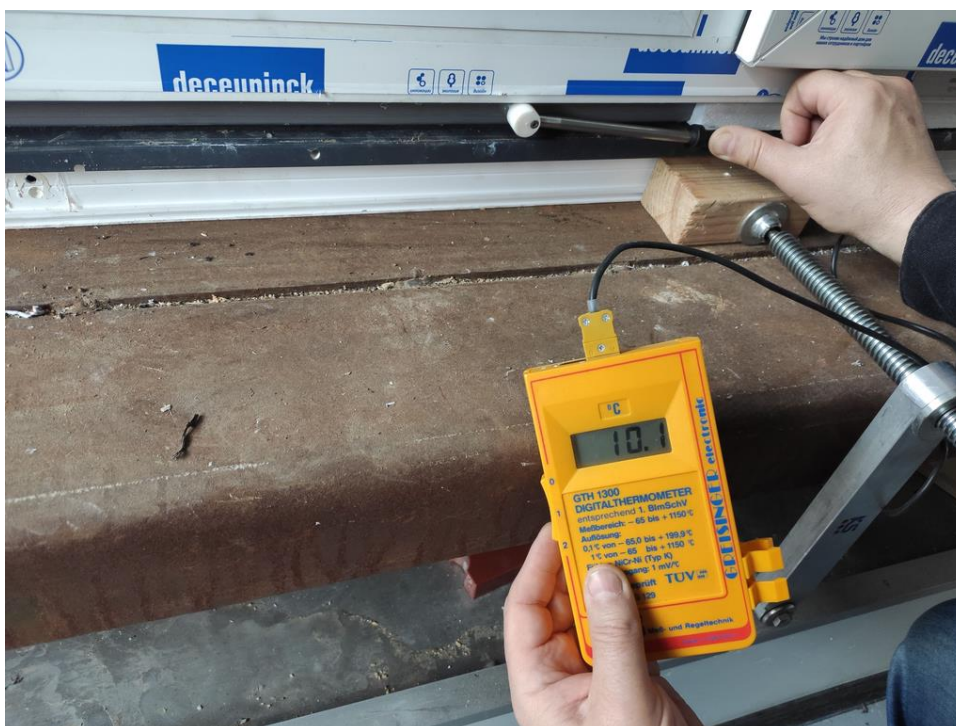
Рис. 23. Оконный блок Vautes Neo. Замер температуры поверхности стандартного подставочного монтажного профиля UST 25.
