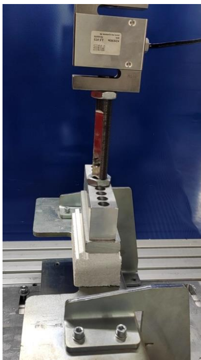
Рис. 31. Испытания на определение предельной прочности на сжатие монтажного подставочного профиля COMRACFOAM®.
